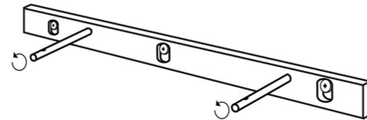
4. Schiebe das Brett auf die Metallstifte. Die Löcher sollten dabei auf der Unterseite liegen. Nun kannst Du die Madenschrauben mit dem Inbusschlüssel richtig fest ziehen.
